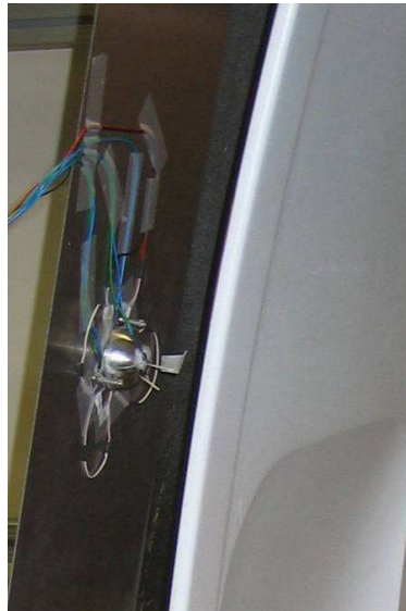
Abbildung 2: Demonstrator mit der Erfindung, hinter der Kabinenverkleidung ist die Flugzeugaußenwand nachgebildet, auf dieser befindet sich die Erfindung. So steht sie über die Außenhaut in thermischem Kontakt mit der Umwelt.
